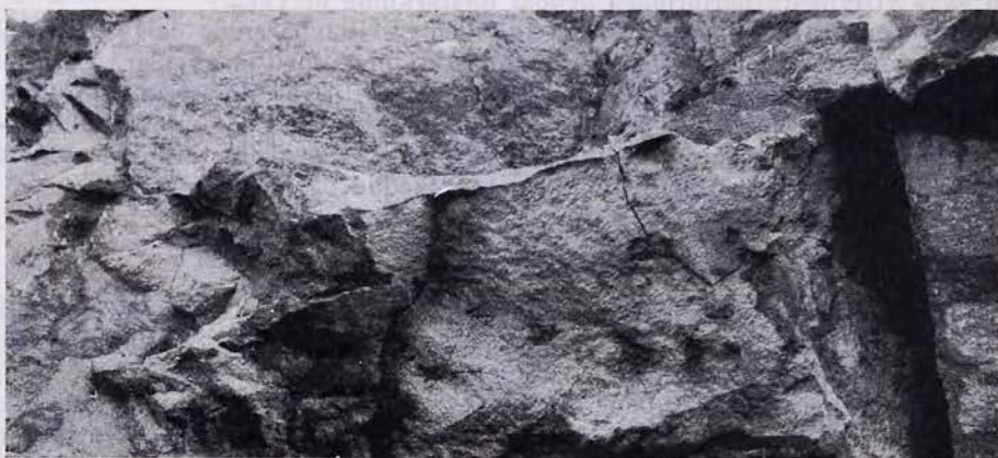
Bild 4. Närbild av brottylorna efter sprängningen.
